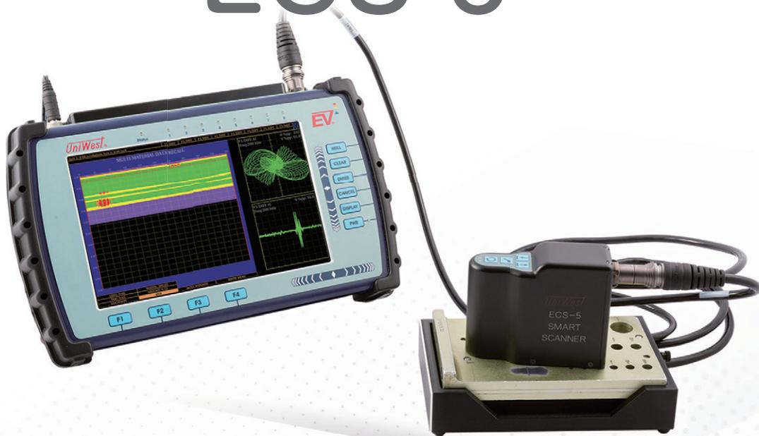
難易度の高いボルトホールの検査を、スピーディーに、そして正確に行います。リアルタイムでCスキャンイメージをディスプレイに描画、きずの位置・サイズを一目で把握することができます。従来のボルトホールスキャナーでは、複数の材料から構成されるボルトホールについては、材料毎に検査を行う必要がありましたが、ECS-5では1度の測定で検査することができます。
