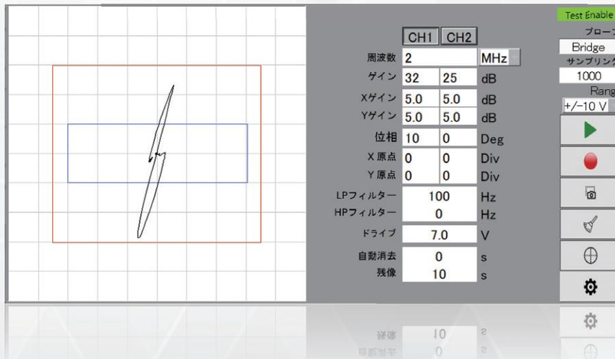
VMECは、手動検査による金属部品の割れ検出や異材判別に最適な、手のひらサイズの渦流探傷器です。圧倒的なコンパクトサイズながら、2Hz~37MHzの周波数および最大20Vのプローブドライブに対応、上置プローブから大型の貫通コイルまで様々なプローブに対応します。さらに、1秒間に最大7,800点の高速サンプリング、2つのアラーム設定など、上位機種に劣らない素晴らしい探傷能力を備えています。
