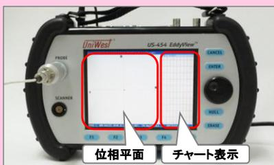
「DISPLAY」キーを押してディスプレイを切り替える。位相平面をメイン画面(左側)にする。
